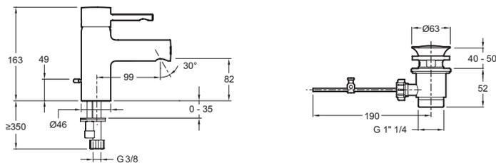
Descriptif CCTP : Mitigeur lavabo - modèle Medium - avec flexibles d'alimentation PEX. E37041. Collection : CÜFF. POIDS : 1,4 kg. NORMES ET RÉGLEMENTATIONS : NF : I - ECAU : E00 Ch2 A3 U3 (Ps3) - ACS : 10 ACC LY 113. TYPE : Mitigeur. DÉBIT (L/MN SOUS 3 BARS) : 5 l/mn. HAUTEUR TOTALE DU ROBINET (MM) : 163. SAILLIE DU BEC (MM) : 99. RACCORDS : Avec flexibles d'alimentation. MÉCANISME : Cartouche à disques céramique. Bonde de vidage en métal.
